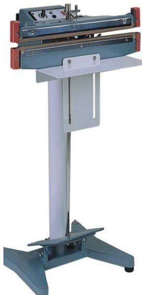
Le saldatrici sono dotate di doppia lama saldante (superiore ed inferiore); possono quindi saldare anche buste con alette (soffietto) o di forte spessori. Sono dotate di piano di appoggio regolabile. Permettono di lavorare con tutte e due le mani, stando seduti. Ideali per fare grandi produzioni in breve tempo.
